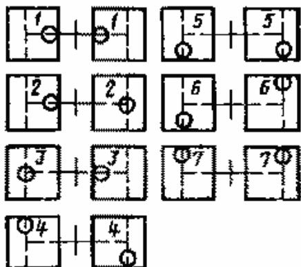
На настольных гирных и циферблатных весах с двумя площадками парные образцовые гиры размещают в центре площадок, а затем в положения, указанные на чертеже. Если при каком-либо положении гиры настольные гирные весы не придут в положение равновесия, то при помещении на соответствующую чашку гири-допуска, равной по массе допускаемой погрешности, указатели должны сойтись или перейти положение равновесия.
